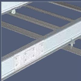
Ossature primaire utilisée obligatoirement lorsque la hauteur du plénum est supérieure à 2m (DTU 58-1)
